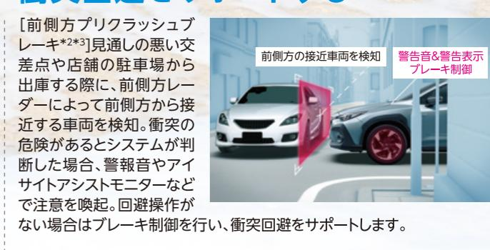
\*1:制御対象との速度差が約60km/h/右左折時は自車速約20km/h、横断自転車は自車速約60km/h)を超える場合は、アイサイトの性能限界から衝突を回避することはできま
